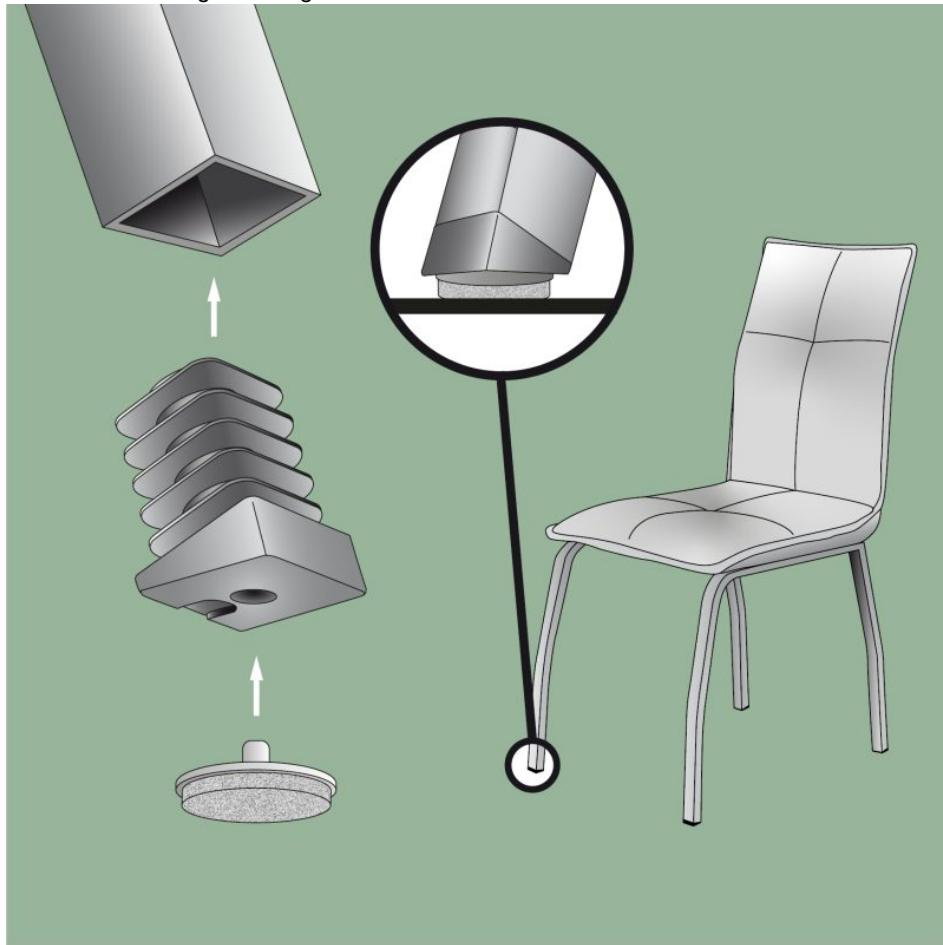
Bei Verschleiß oder Wechsel des Belags lassen sich die Gleitaufsätze im Handumdrehen austauschen (Bild: Wagner System).
