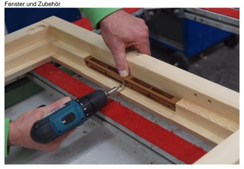
Mit drei Schrauben ist der Fensterlüfter schnell in der vorgefrästen Aussparung festgeschraubt (Bild: Regel-air).
