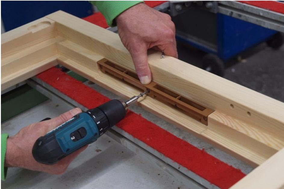
Mit drei Schrauben ist der Fensterlüfter schnell in der vorgefrästen Aussparung festgeschraubt (Bild: Regel-air).
