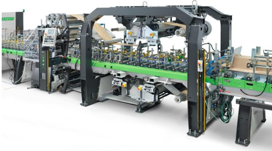
Maschine zur simultanen Kaschierung von oben und unten inkl. Rollenwechsler oben und unten sowie mitlaufender Diagonalsäge (Bild: Düspohl).
