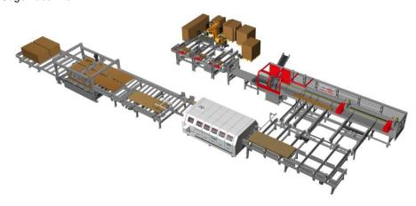
Vollautomatische Zuschnittanlage mit Beschickung, flexibler Mehrblattkreissäge, Schieberkappsäge und Sortierroboter (Bild: Paul).
