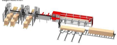
Kappsäge mit automatischem Schiebesystem, Zangengreifer und spezieller Stapelanlage (Bild: Reinhardt).
