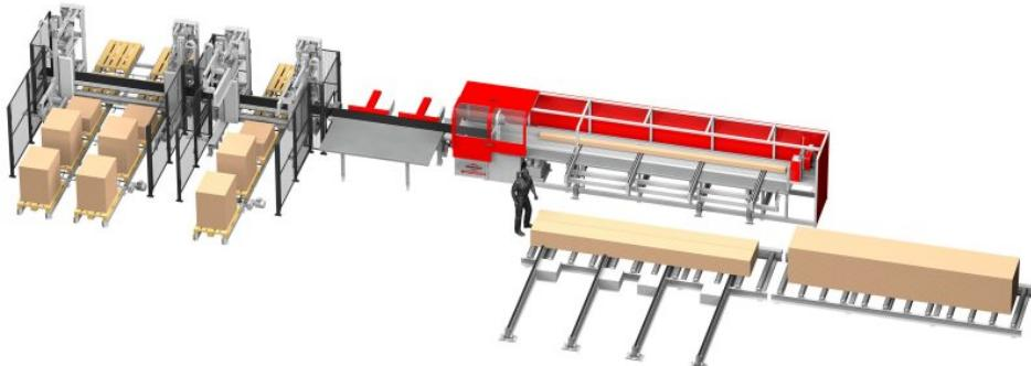
Kappsäge mit automatischem Schiebesystem, Zangengreifer und spezieller Stapelanlage (Bild: Reinhardt).
