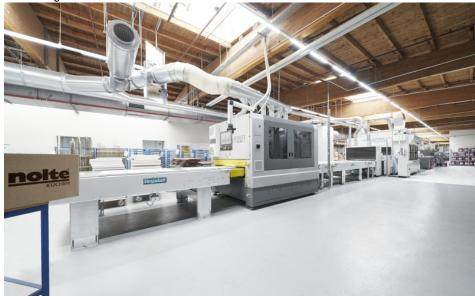
Bild der neuen Lackierstraße inklusive Entstaubungsanlage, Förder- und Trocknungstechnik (Bild: Venjakob).
