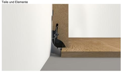
Das Befestigungssystem sorgt für eine einfache und saubere Montage der Bodenleisten (Bild: Neuhofer).
