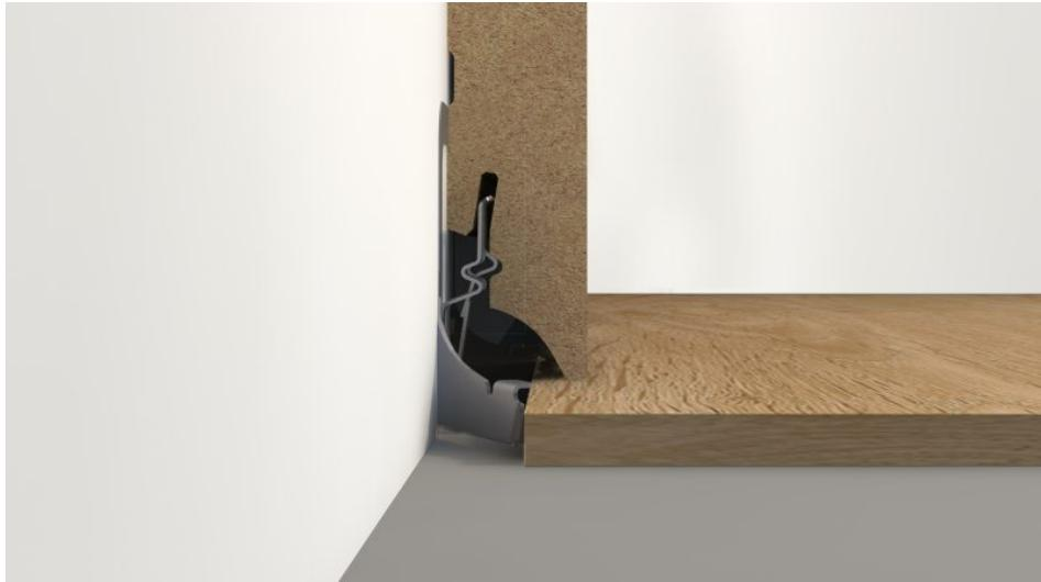
Das Befestigungssystem sorgt für eine einfache und saubere Montage der Bodenleisten
