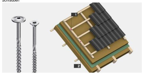
Mögliche Einsatzbereiche für Holzschrauben bei der Aufsparrendämmung: Verbindung einer 30 mm dicken Traglatte auf eine 40 mm dicke Konterlatte (1) und Befestigung einer Aufsparrendämmung (2) (Bild: Ejot).
