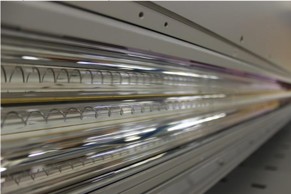
Mittels Excimer-Technologie können hochresistente und besonders matte Oberflächen erzielt werden (Bild: IST Metz).
