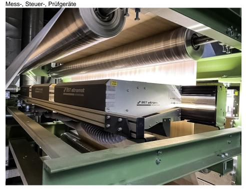
Das Inspektionssystem von BST erkennt im laufenden Betrieb Fehler in Echtzeit und liefert detailreiche Farbbilddaten (Bild: Schattdecor).
