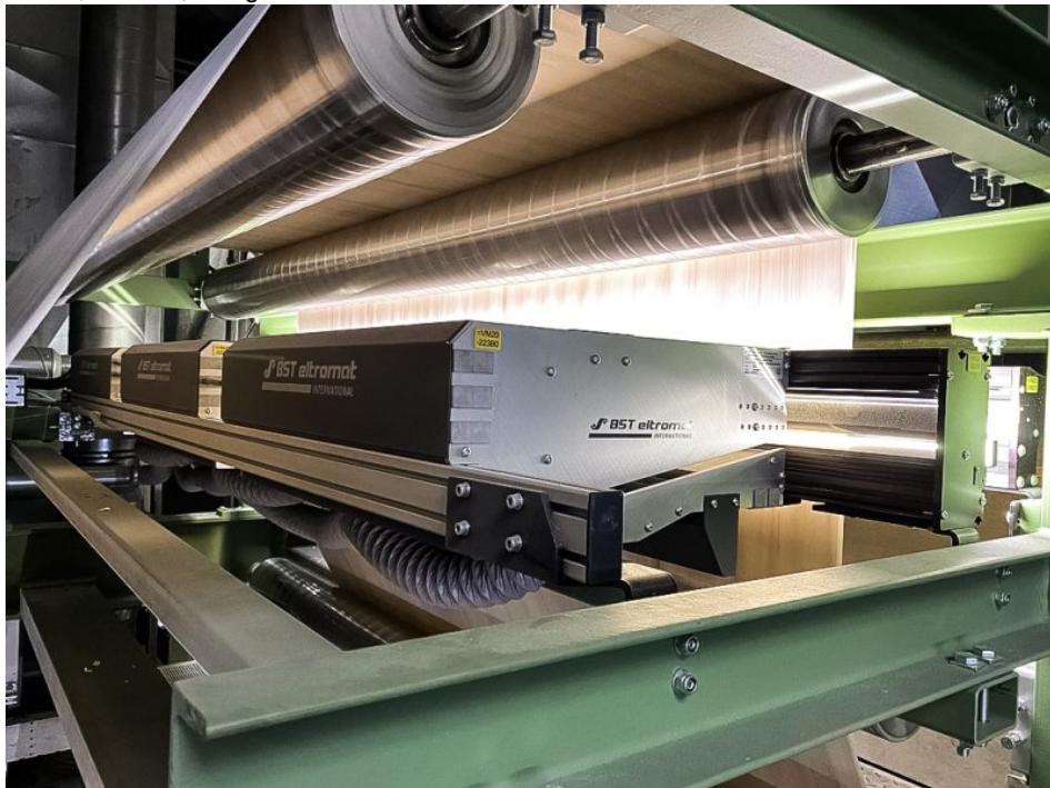
Das Inspektionssystem von BST erkennt im laufenden Betrieb Fehler in Echtzeit und liefert detaillierte Farbbilddaten (Bild: Schattdecor).
