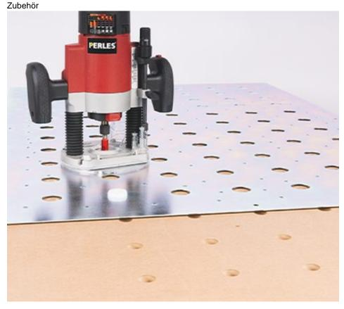
Die Schablone wird auf der zukünftigen Arbeitsplatte befestigt, das gewünschte Lochraster übertragen und gebohrt (Bild: sautershop).
