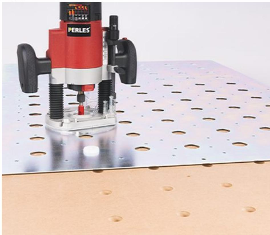
Die Schablone wird auf der zukünftigen Arbeitsplatte befestigt, das gewünschte Lochraster übertragen und gebohrt (Bild: sautershop).
