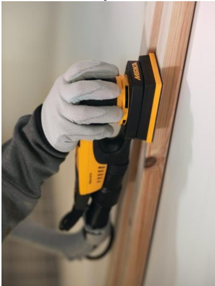
Kompakter Elektro-Schwingschleifer für das effiziente Schleifen von Türen und Rahmen
