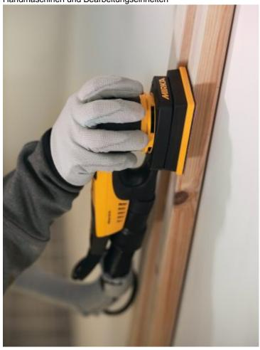
Kompakter Elektro-Schwingschleifer für das effiziente Schleifen von Türen und Rahmen (Bild: Mirka).
