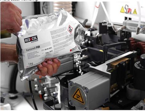
Hier wird das PUR-Klebstoffgranulat ins Leimbecken eingefüllt (Bild: Ostermann).
