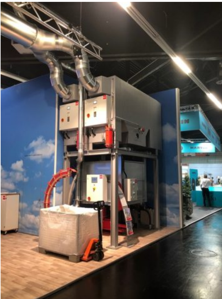
Entstauberbatterie auf dem Messestand (Bild: Spänex).
