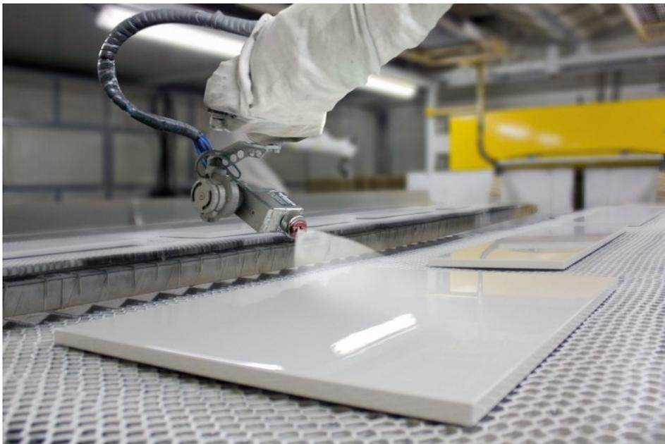
Automatische Nasslackapplikation für Holzwerkstücke (Bild: Wagner).
