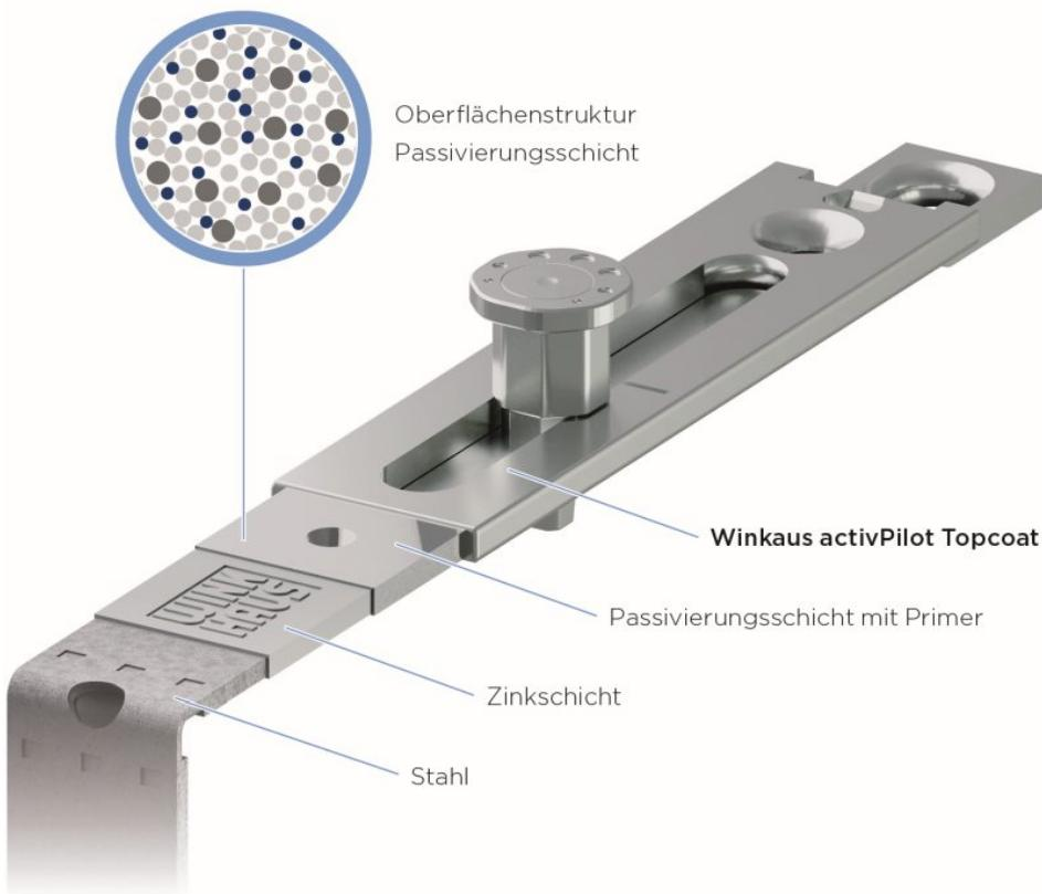
Auch extremen Umwelteinflüssen hält der Fensterbeschlag dank seiner besonders widerstandsfähigen Oberfläche stand. Vier Schichten umhüllen den massiven Stahlkern und sorgen für seine hohe Langlebigkeit und Funktionalität (Bild: Winkhaus).
