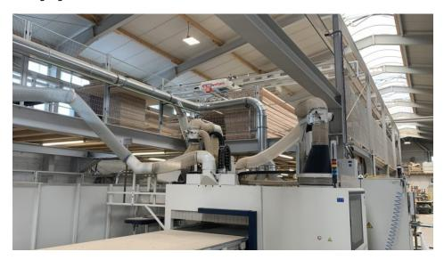
Das neue Flächenlager wurde platzsparend über dem CNC-Bearbeitungszentrum angebracht (Bild: Barbaric).
