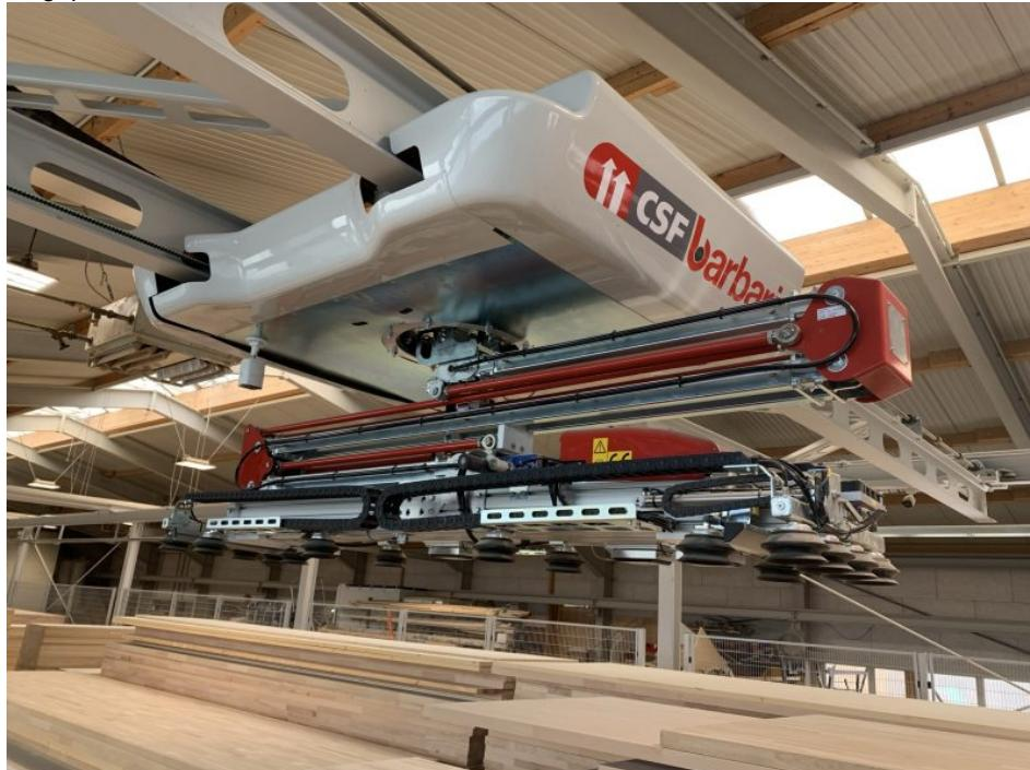
Lagersystem mit Spezialtraverse zur Aufnahme verschiedener Plattenteile. Integrierte Feuchtigkeitssensoren messen die Feuchte in den Teilen, die Werte werden in der Steuerung mit den Sollwerten verglichen. Mithilfe eines anpassbaren Schwellenwerts wird entschieden, ob die Platte eingelagert werden kann oder auf sogenannte Trocknungsstapel gelegt wird (Bild: Barbaric).
