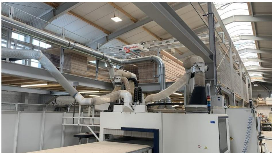
Das neue Flächenlager wurde platzsparend über dem CNC-Bearbeitungszentrum angebracht (Bild: Barbaric).
