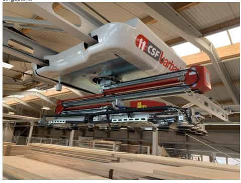
Lagersystem mit Spezialtraverse zur Aufnahme verschiedener Plattenteile. Integrierte Feuchtigkeitssensoren messen die Feuchte in den Teilen, die Werte werden in der Steuerung mit den Sollwerten verglichen. Mithilfe eines anpassbaren Schwellenwerts wird entschieden, ob die Platte eingelagert werden kann oder auf sogenannte Trocknungsstapel gelegt wird (Bild: Barbaric).
