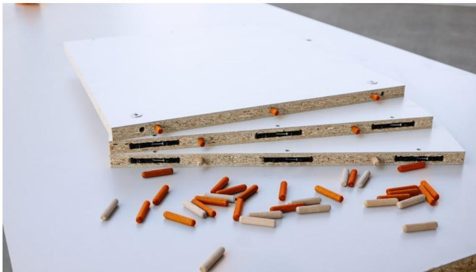
Präzise rundum gefräste und gebohrte Werkstücke für unterschiedliche Möbelverbinder
