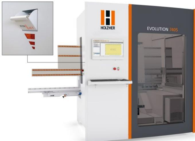
Mit der neuen Funktionserweiterung meistert das CNC-Bearbeitungszentrum das vollautomatische Einsetzen von Holzdübeln (Bild: Holz-Her).
