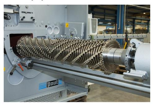
Die Mehrblattkreissäge mit ausgezogener Sägewelle, auf der die 56 Nutwerkzeuge und zwei Randzerspaner montiert sind (Bild: Paul).
