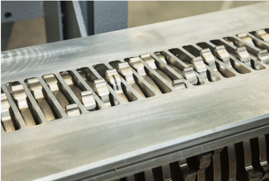
Die Auflage an den Nutwerkzeugen sorgt für eine sichere Führung der Werkstücke (Bild: Paul).
