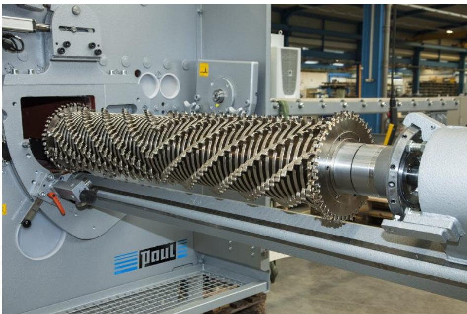
Die Mehrblattkreissäge mit ausgezogener Sägewelle, auf der die 56 Nutwerkzeuge und zwei Randzerspaner montiert sind (Bild: Paul).
