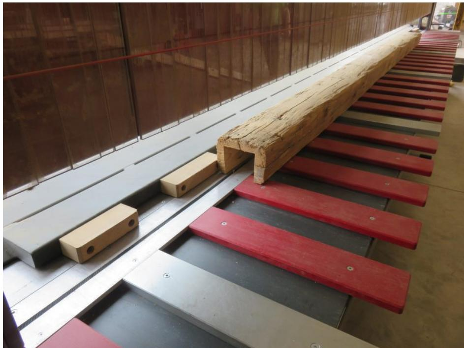
Die u-förmig ausgehöhlten Balken werden von der Säge automatisch ohne manuelle Eingriffe hergestellt (Bild: Stoll).
