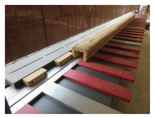
Die u-förmig ausgehöhlten Balken werden von der Säge automatisch ohne manuelle Eingriffe hergestellt (Bild: Stoll).
