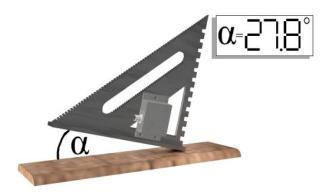
Neigungssensoren werden für Aufgaben verwendet, die beispielsweise das exakte Messen von Winkeln erfordern (Bild: a.b.jödden).
