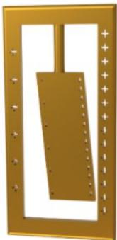
Durch die Neigung oder Beschleunigung in die entgegengesetzte Messrichtung ergibt sich ein negatives Signal. Daher spricht man von zum Beispiel ±90° (Bild: a.b.jödden).
