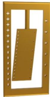
Durch die Neigung in horizontaler Richtung (nach rechts) neigt sich der Biegebalken. Dies ergibt eine (positive) Kapazitätsveränderung, deren hohes Nutzsignal sehr rauscharm ist (Bild: a.b.jödden).
