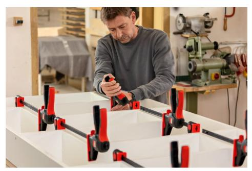
Je nach Arbeitssituation kann die ergonomischste Pumpposition gewählt werden, um das Werkstück bequem und sicher zu fixieren (Bild: Bessey).
