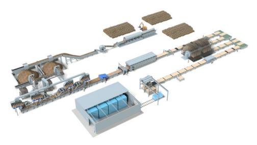
Die Bandlösungen decken alle Transportprozesse in einer Holzplatten-Fertigungsstraße ab (Bild: Habasit).
