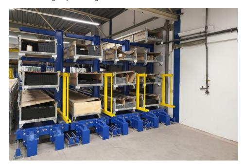
Manuell längs ausziehbares Langgut-Kompaktlager für Abstandhalter, Sprossen oder Glasleisten. Die einzelnen Regale können individuell gestaltet werden (Bild: Hegla).
