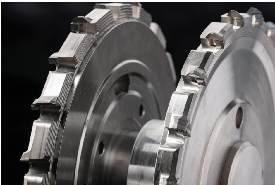
Leiser, schneller und schonender zerspanen: Der überarbeitete Zerspaner erlaubt Vorschübe bis 100 Meter pro Minute bei Platten ab acht Millimeter Stärke (Bild: Leuco).
