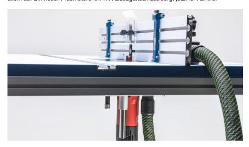
Der integrierte Absauganschluss am Fräsmotorenlift sorgt für sauberes Arbeiten und schützt den Fräsmotor (Bild: sauter).
