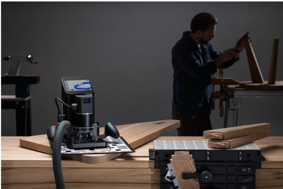
Die neue digitale Oberfräse gleicht Ungenauigkeiten beim manuellen Führen automatisch aus (Bild: Shaper Tools).
