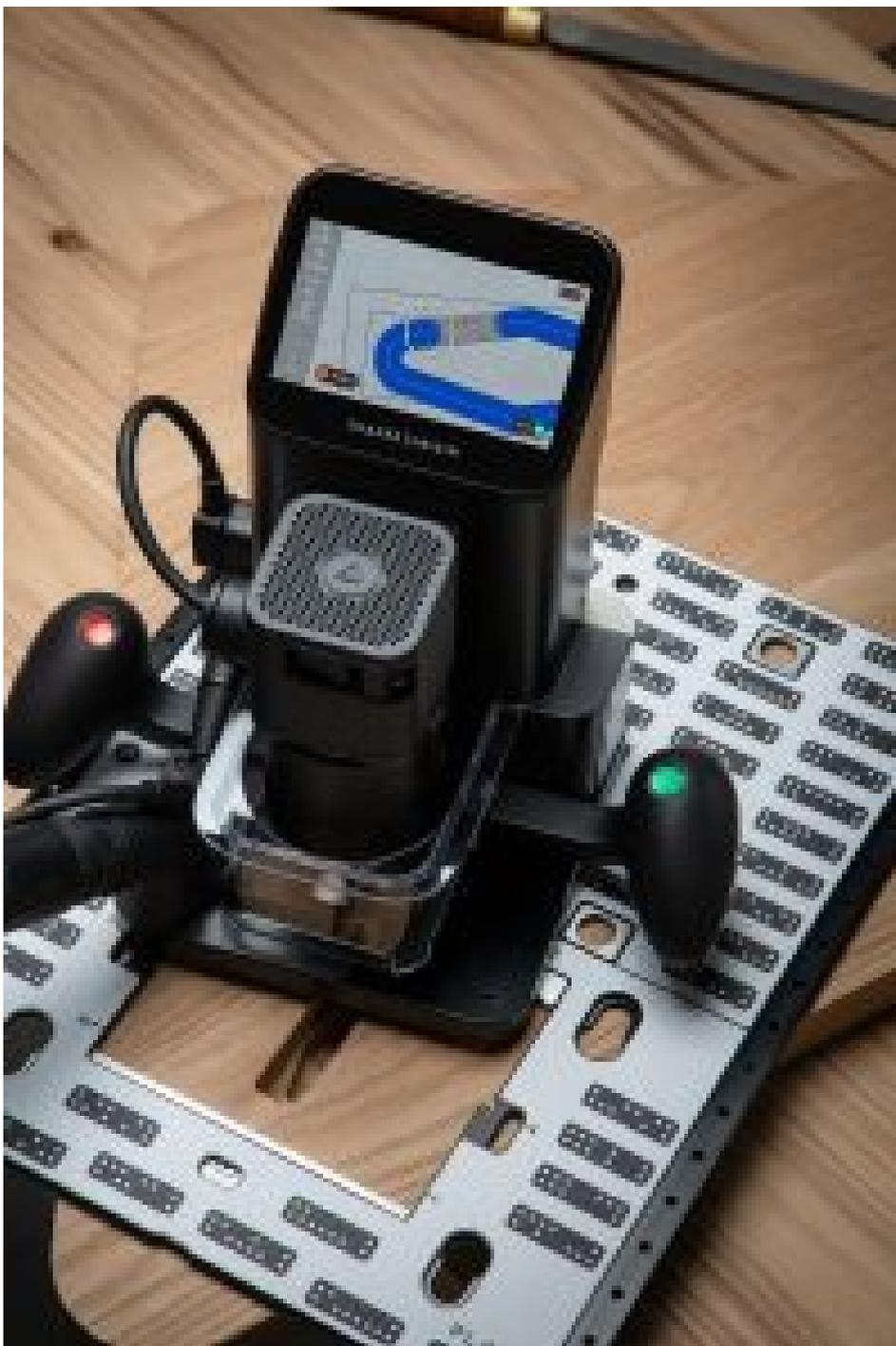
Der Arbeitsbereich wird mit der Kamera der Maschine eingescannt, wodurch ein digitales Abbild der Oberfläche entsteht (Bild: Shaper Tools).
