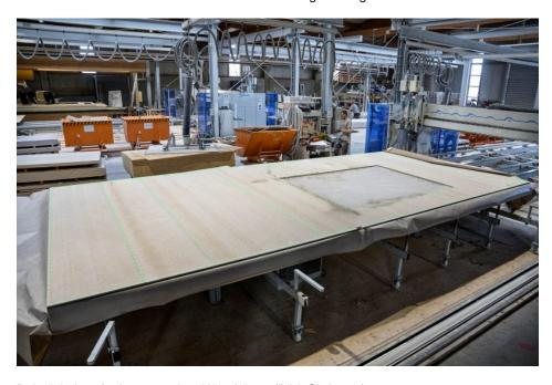
Beispiel einer fertig genagelten Wandplatte (Bild: SL-Laser).
