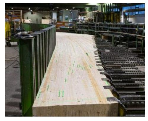
Durch die Projektion der fertigen Kontur des Leimbinders kann man den Laserprojektor auch beim Abbund einsetzen (Bild: SL-Laser).
