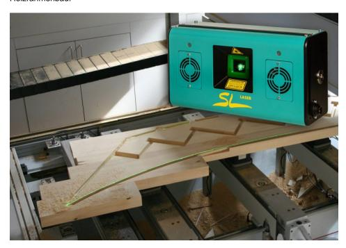
Das Laserprojektionssystem ermöglicht die schnelle Positionierung von Saugern und Werkstücken (Bild: SL-Laser).
