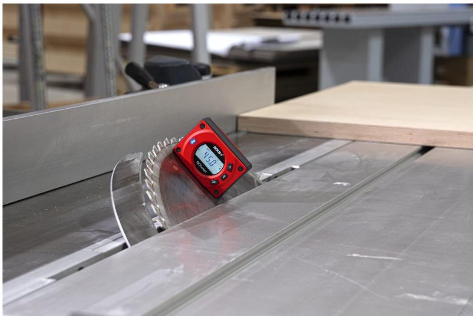
Das digitale Messwerkzeug misst sämtliche Neigungen und Winkel mit sehr hoher Präzision (Bild: Sola Messwerkzeuge).
