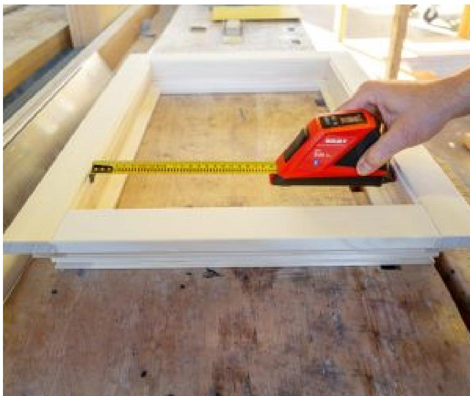
Mit einem Knopfdruck lässt sich der Messreferenzpunkt an der Vorder- oder Hinterkante einstellen (Bild: Sola Messwerkzeuge).
