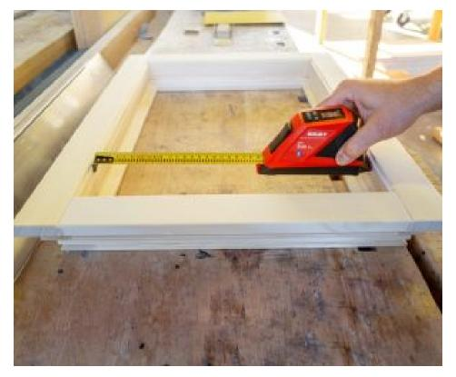
Mit einem Knopfdruck lässt sich der Messreferenzpunkt an der Vorder- oder Hinterkante einstellen (Bild: Sola Messwerkzeuge).
