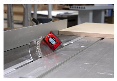
Das digitale Messwerkzeug misst sämtliche Neigungen und Winkel mit sehr hoher Präzision (Bild: Sola Messwerkzeuge).
