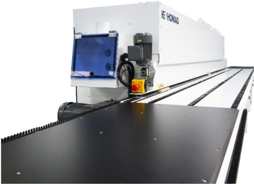
Ergonomischer Luftkissentisch am Maschineneinlauf und -auslauf (Bild: Homag).
