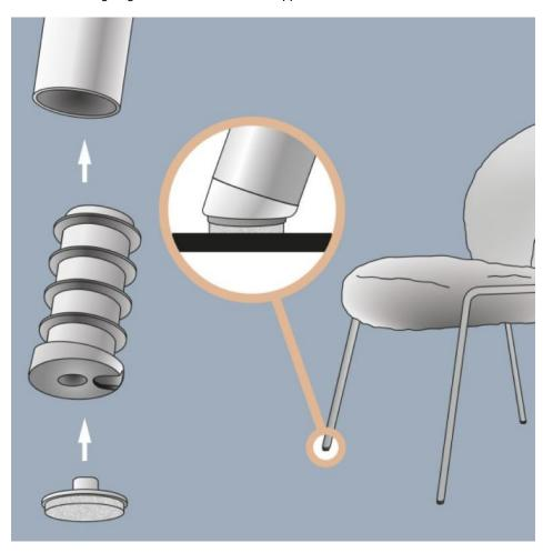
Durch seine frei wählbare bodenschonende Ausstattung schützt »QuickClick Smart« jede Art von Bodenoberflächen vor Schäden (Bild: Wagner).
