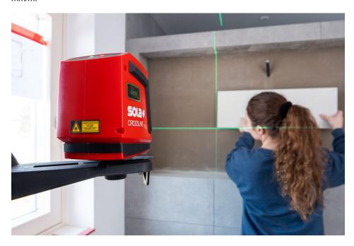
Mit einer maximalen Messtoleranz von  $\pm 0,2$  mm/m eignet sich der Kreuzlinienlaser für präzises Nivellieren (Bild: Sola).
