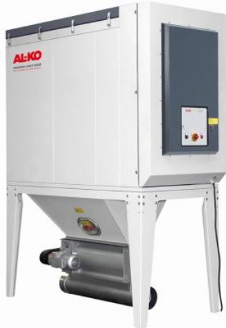
Der mobiler Reinluftentstauber ist mit kraftvollem IE4-Antrieb ausgestattet (Bild: Al-Ko).
