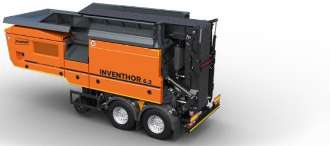
Der Zerkleinerer verfügt über einen optimierten Klapptrichter, der das Beladen mit Bagger oder Radlader vereinfacht (Bild: Doppstadt).
