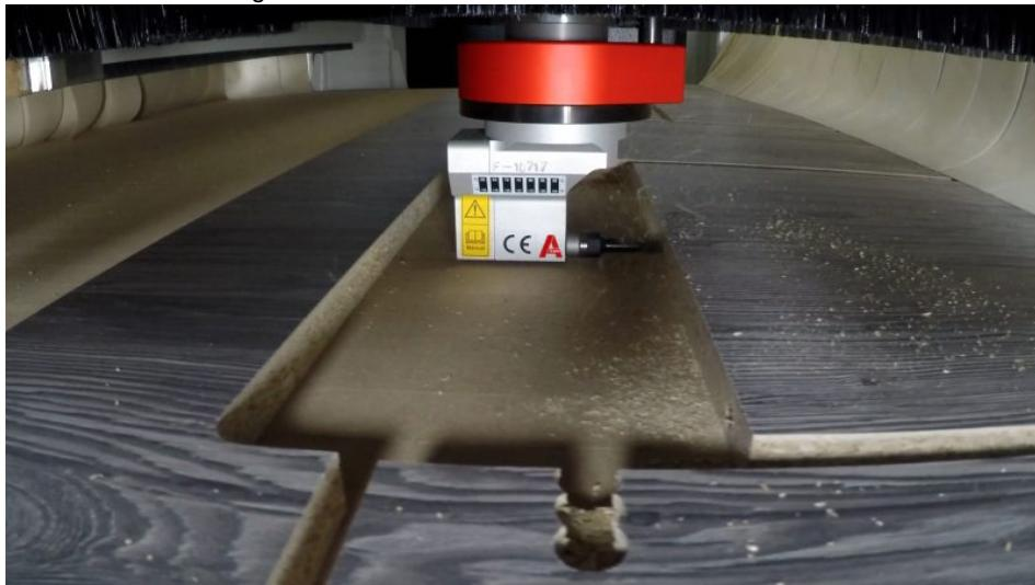
Das kompakte Winkelaggregat ermöglicht das präzise Bohren in Kanten (Bild: Atemag).
