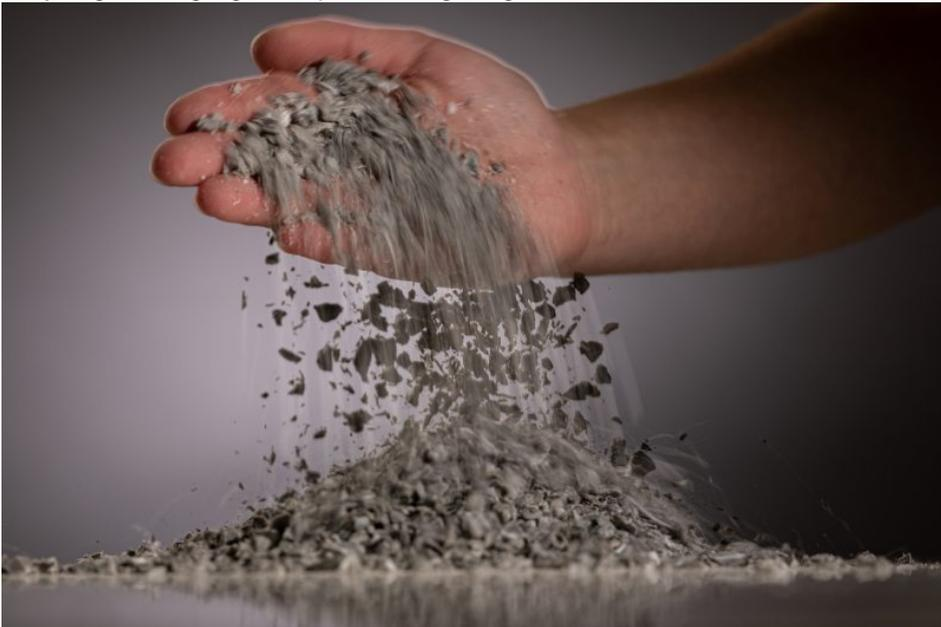
Die unverarbeiteten Kantenbänder werden zu Regranulat aufbereitet (Bild: Rehau).
