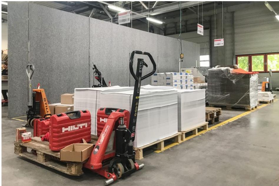
Durch die 2 bzw. 3 m hohe Stellwand ist sowohl eine optische als auch eine akustische Abtrennung möglich (Bild: Sonatech).
