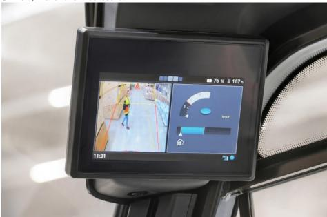
Die Rückfahrkamera ist KI-basiert und kann zwischen Personen und Gegenständen unterscheiden (Bild: Linde Material Handling).
