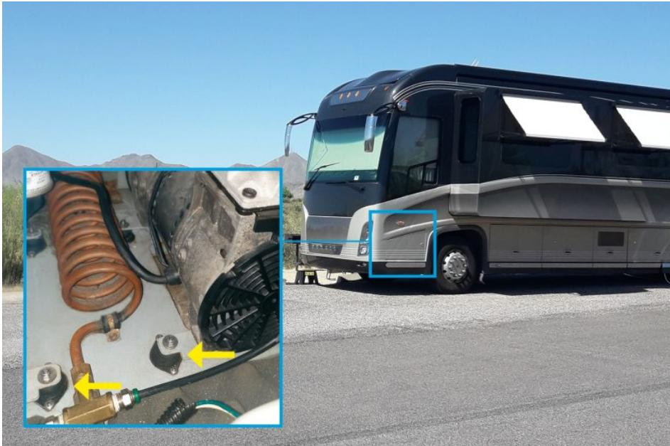
Die Vibrationsisolierung durch Gummi-Metall-Isolatoren von ACE führt zu einer deutlichen Verringerung von Lärmemissionen (Bild: Peter van Dijk).
