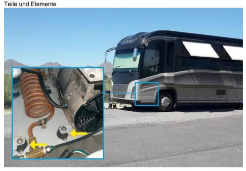
Die Vibrationsisolierung durch Gummi-Metall-Isolatoren von ACE führt zu einer deutlichen Verringerung von Lärmemissionen (Bild: Peter van Dijk).
