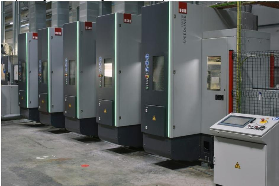
Im Kern der neuen Anlage sorgen fünf Hochleistungs-Dünnschnitt-Bandsägen für höchstmögliche Materialausbeute (Bild: Fill).
