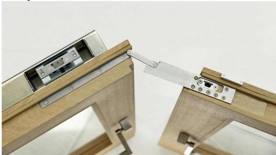
Das Mitnehmerklappensystem wird im Falzraum an der Türoberseite montiert und ist dadurch bei geschlossener Tür nicht erkennbar (Bild: Assa Abloy).
