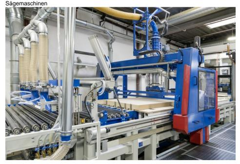
Die leistungsstarke Portal-Aufteilsäge ist für Großformatplatten bis 6500 mm Länge und eine Pakethöhe von 165 mm ausgelegt (Bild: MHF).
