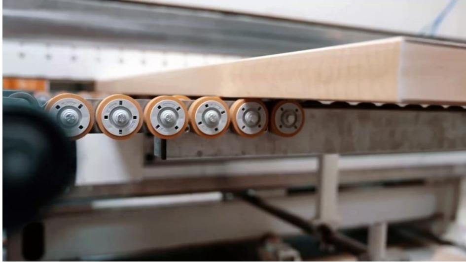
Für die Holzindustrie werden die Transportrollen z. B. mit Kunststoffbandagen aus zelligem Vulkollan gefertigt (Bild: Torwegge).
