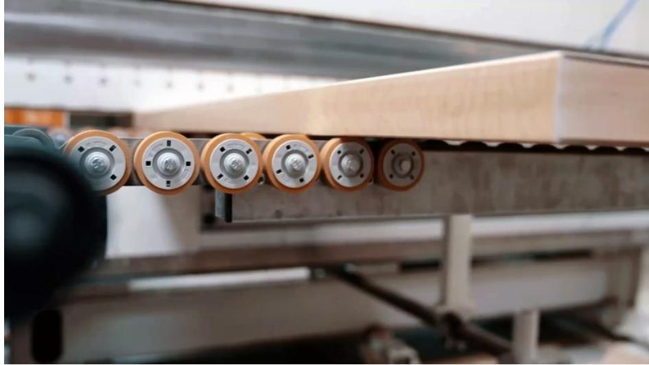
Für die Holzindustrie werden die Transportrollen z. B. mit Kunststoffbandagen aus zelligem Vulkollan gefertigt (Bild: Torwegge).
