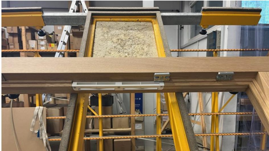
Die Fensterfalzlüfter werden direkt bei der Herstellung in die Fenster integriert (Bild: Regel-air).
