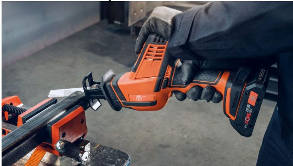
Die Akku-Säbelsäge ist z. B. für grobe Schnitte, Demontagearbeiten und bündiges Abschneiden geeignet (Bild: Fein).
