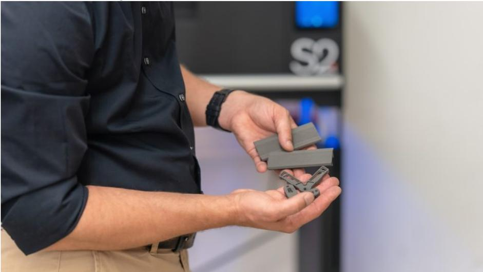
Profile und Fensterkomponenten werden mit dem SLS-3D-Drucker aus PA12 gesintert (Bild: Sintratec).
