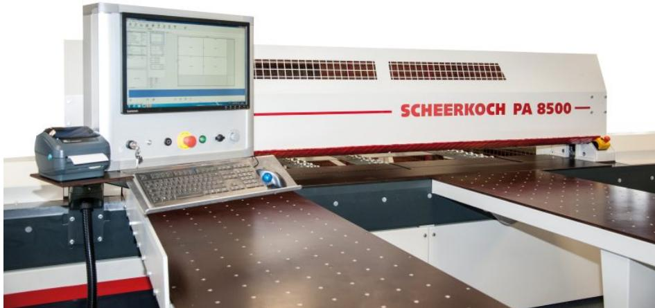
Die kompakte Platten-Aufteilsäge verfügt über einen Sägewagen mit Direktantrieb und einen vollautomatischen Winkelanpresser (Bild: Hans Koch GmbH).
