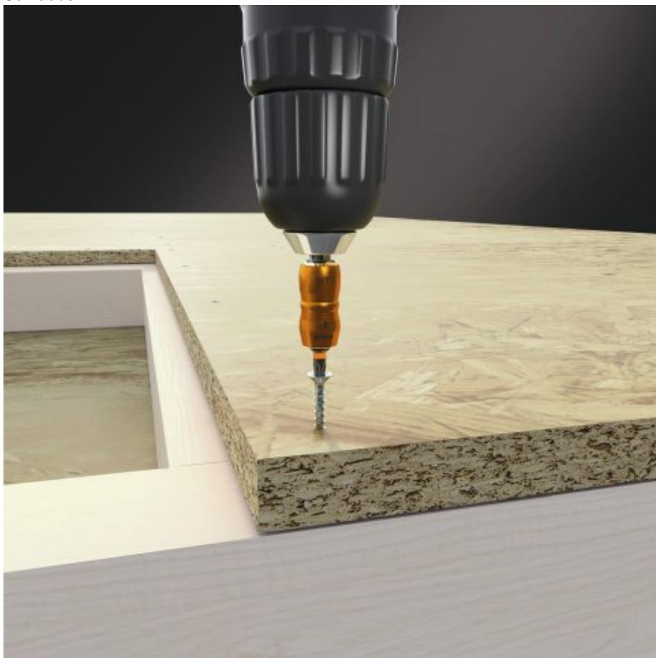
Die Gewindesteigung ist auf die Schraubenlänge angepasst, bei kurzen Schrauben verhindert eine geringe Gewindesteigung das Überdrehen bei gleichzeitig sicherer Befestigung (Bild: Heco).
