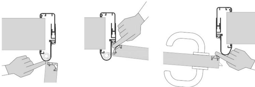
Die in die Türkanten integrierten Fingerschutzprofile vermindern das schmerzhafte Einklemmen oder Quetschen von Kinderfingern (Bild: Küffner).
