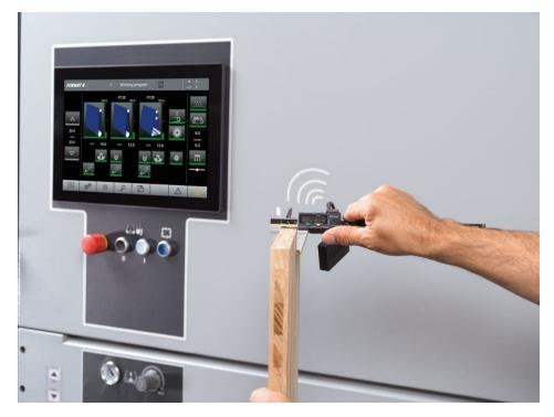
Dank Messwertübermittlung über Funk ist die Vermessung der Werkstücke direkt vor der Maschine möglich (Bild: Felder).
